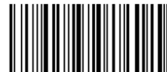
在使用USB 通讯接口时,可以将扫描器模拟成HID-KBW 设备。在这种模式下,扫描器将成为一个虚拟键盘向主机输出数据。
