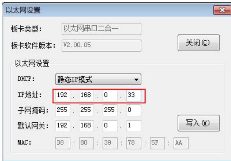
图■ 打印机 IP 地址
